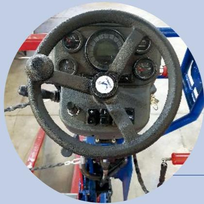
El tablero cuenta con una botonera para luces de emergencia, encendido y apagado de focos de trabajo y funciones de velocidades rápidas o lentas. Además cuenta con componentes básicos como horómetro, temperatura motor, RPM, temperatura del aceite hidráulico e indicadores de batería y combustible.
